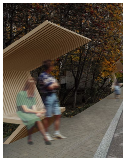
3. На изолированных от проезда автомобилей участках возводятся скамейки с навесом от солнца. В конструкции применен влагоустойчивый деревянный брус
